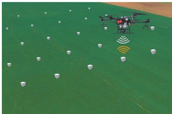
5. ábra: A drón a chip-nélküli, a talajban lebomló szenzorok jeleit „gyűjti”
